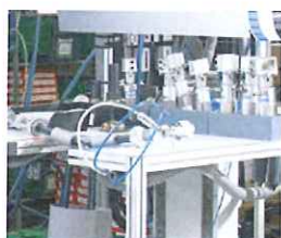
Banc de tests d'étanchéité
