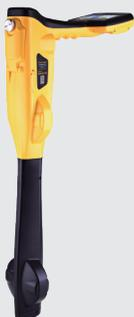
**vLoc3-Cam** – le détecteur de sondes vLoc3-Cam est l'outil ultime pour la détection de sondes & caméras ayant pour fréquences 512Hz, 640Hz, 8.19kHz, 9.82kHz, 33kHz, et 83kHz. De plus, il est équipé de deux modes passifs : Radio et 50Hz pour détecter la présence de câbles électriques, CATV, télécom et les conduites métalliques induites à proximité de ces réseaux. Lecture de la profondeur directe avec affichage permanent à l'écran.
